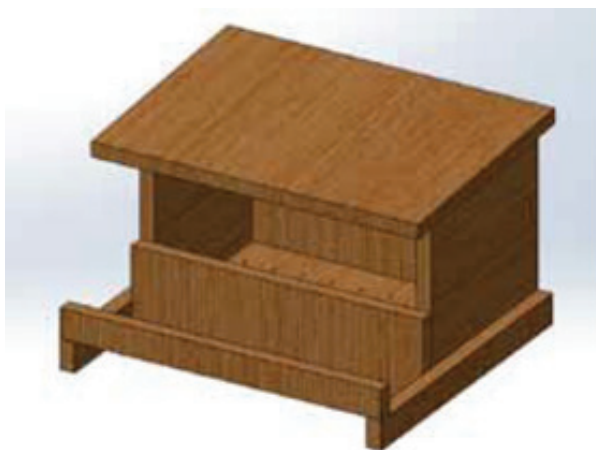
Afbeelding 5.3. Constructie van nestkasten voor Torenvalken zoals toegepast in Litouwen op hoogspanningsmasten. De afmetingen betreffen hoogte 31 cm, diepte 31 cm, breedte 50 cm (Raudonakis & Morkūnas 2018).
