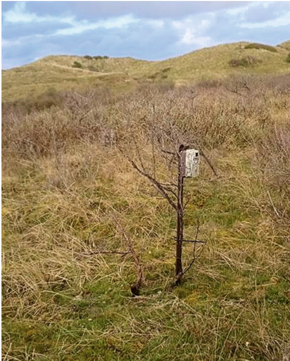
Figuur 1. Cameraval gemonteerd op een ijzeren staaf en gecamoufleerd met duindoortakken. De camera staat 50-70 cm boven de grond op 2 m van het (hier niet zichtbare) nest van een Roodborsttapuit, Noord-Hollands Duinreservaat, 28 april 2016. Camera trap attached to an iron pole, camouflaged with branches of Sea Buckthorn. The camera is placed 50-70 cm above the ground, at 2 m from the nest (not visible) of a European Stonechat.
