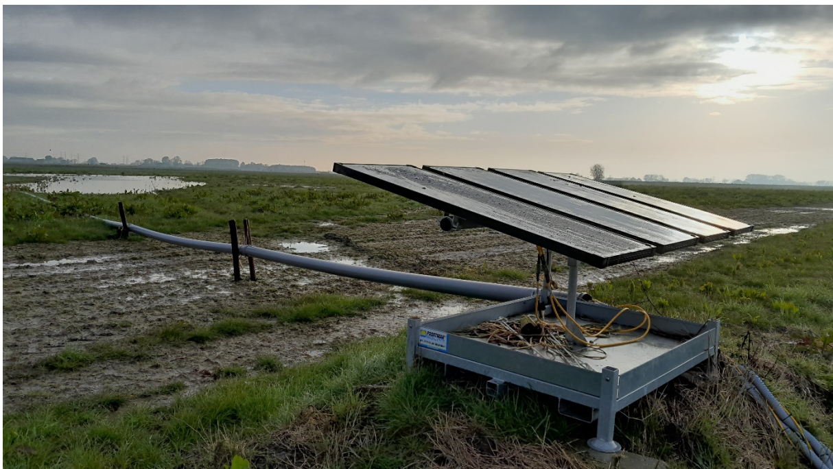
Pompsysteem op zonne-energie voor plasdras nabij Crangeweer. 26 april 2024 (Thijs Glastra).
